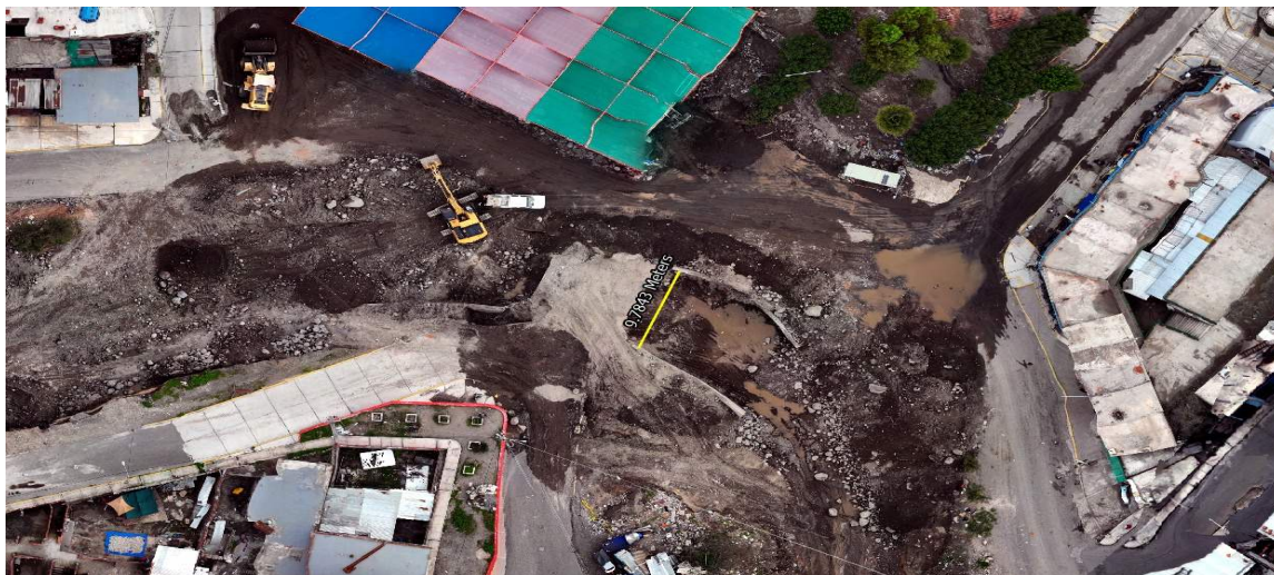
FIGURA N°02: TRAMO CRÍTICO DESDE LA VISTA SATELITAL EN EL PUENTE VILLA CONTINENTAL DONDE LA ALCANTAILLA ES OBSTRUIDA POR EL HUYACO DESBORDÁNDOSE LA QUEBRADA GAMARRA
